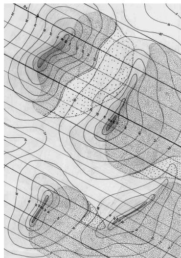
Obr. 8 a) Zasadenie cestného telesa do terénu      b) Rovnobežné osvetlenie topografickej plochy.
